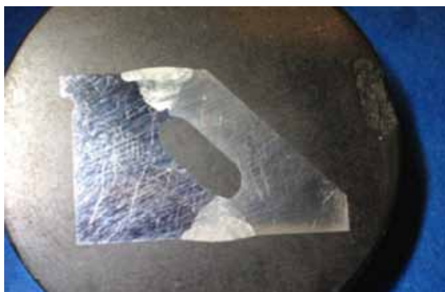
2. Smala och djupa svetsar är ett resultat av mycket liten värmepåverkan.
